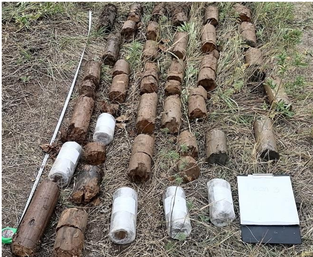
Рисунок 1.2 – Монолиты грунтов, отобранные в ходе буровых работ в соответствии с требованиями ГОСТ 12071-2014
